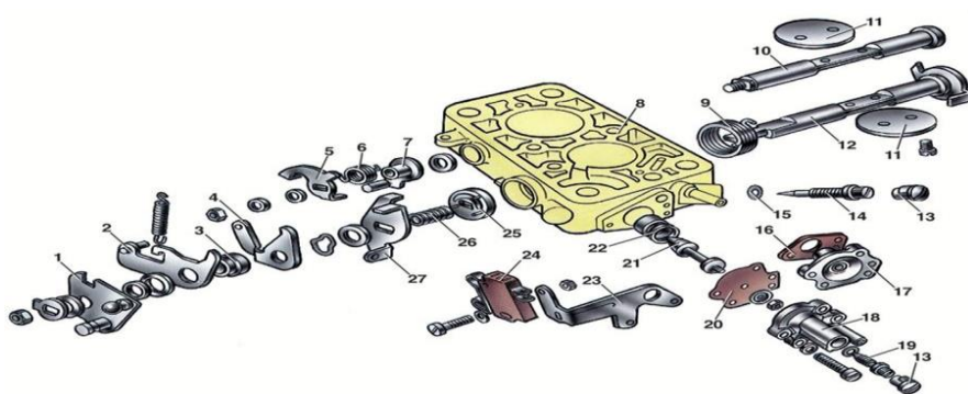
Рис 7. Детали корпуса дроссельных заслонок карбюратора 2107-1107010: 1 – рычаг привода дроссельных заслонок; 2 – рычаг, ограничивающий открытие дроссельной заслонки второй камеры; 3 – втулка; 4 – рычаг связи с воздушной заслонкой; 5 – рычаг, закрепленный на оси дроссельной заслонки второй камеры; 6 – пружина; 7 – рычаг, связанный с пневмоприводом; 8 – корпус дроссельных заслонок; 9 – возвратная пружина первой дроссельной заслонки; 10 – ось второй дроссельной заслонки; 11 – дроссельные заслонки; 12 – ось первой дроссельной заслонки; 13 – ограничительные втулки; 14 – винт регулировки качества смеси холостого хода; 15 – уплотнительное кольцо; 16 – прокладка; 17 – корпус экономайзера принудительного холостого хода; 18 – крышка экономайзера; 19 – винт регулировки количества смеси холостого хода; 20 – диафрагма экономайзера; 21 – игла экономайзера; 22 – седло иглы; 23 – кронштейн крепления микропереключателя; 24 – микропереключатель; 25 – золотник; 26 – пружина золотника; 27 – рычаг, закрепленный на оси первой дроссельной заслонки;
